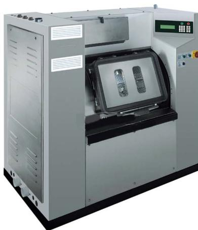
Барьерная стиральная машина с функциями стирки и дезинфекции белья. Предназначена для госпиталей, лабораторий. Главная особенность машины: загрузка белья производится с одной стороны машины, выгрузка - с другой, а сама машина вмонтирована в стену. Машины класса барьерные стиральные - обеззараживают белье, уничтожают стафилококк и другие внутри больничные инфекции, предотвращают повторное и перекрестное заражение.
