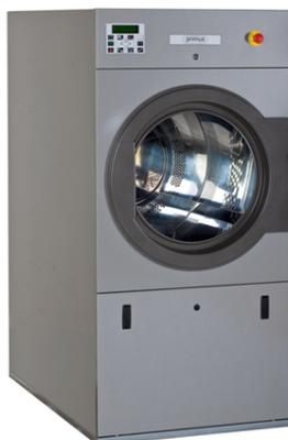
Машина предназначена сушить белье после стирально-отжимной машины. До стирки остаточная влажность 50-80%, после сушки 0-25%. У некоторых моделей комплектация датчиком остаточной влажности. Подключение: 380 вольт, вентиляция (некоторые малые модели могут иметь питание 220 в и не требовать подключения к вентиляции). Управление - компьютер с разными программами, возможности подключения дополнительных опций.
